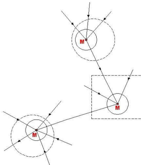
Angenäherter Trassenverlauf mittels Verbindung der Schachtdeckel-Mittelpunkte. Die Schachttiefe entspricht jener des Hauptgerinnes bzw. Unterkante der Rohrleitung, ebenso jene der seitlichen Zuleitungen bei bescheidenen Höhenunterschieden.
